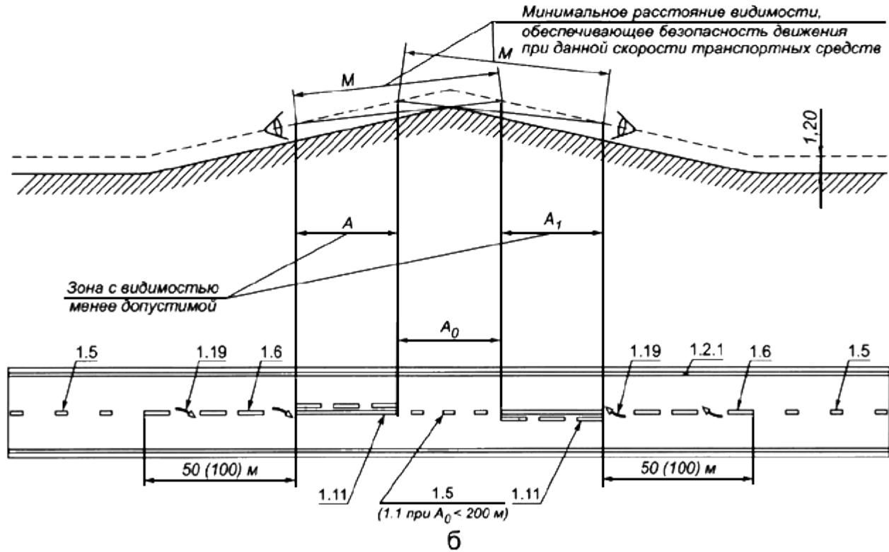
Рисунок В.6 - Примеры нанесения разметки на участках дорог с необеспеченной видимостью, где зоны видимости встречного автомобиля: а - перекрываются; б - не перекрываются
