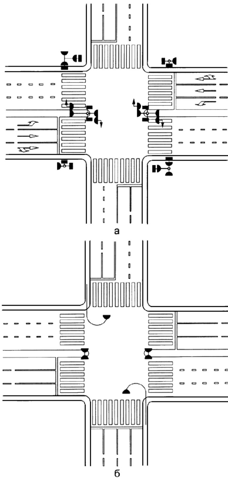
Рисунок В.24 - Пример размещения светофоров:
